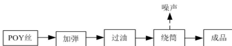
图 2-5-2 化纤丝加弹生产工艺流程图
