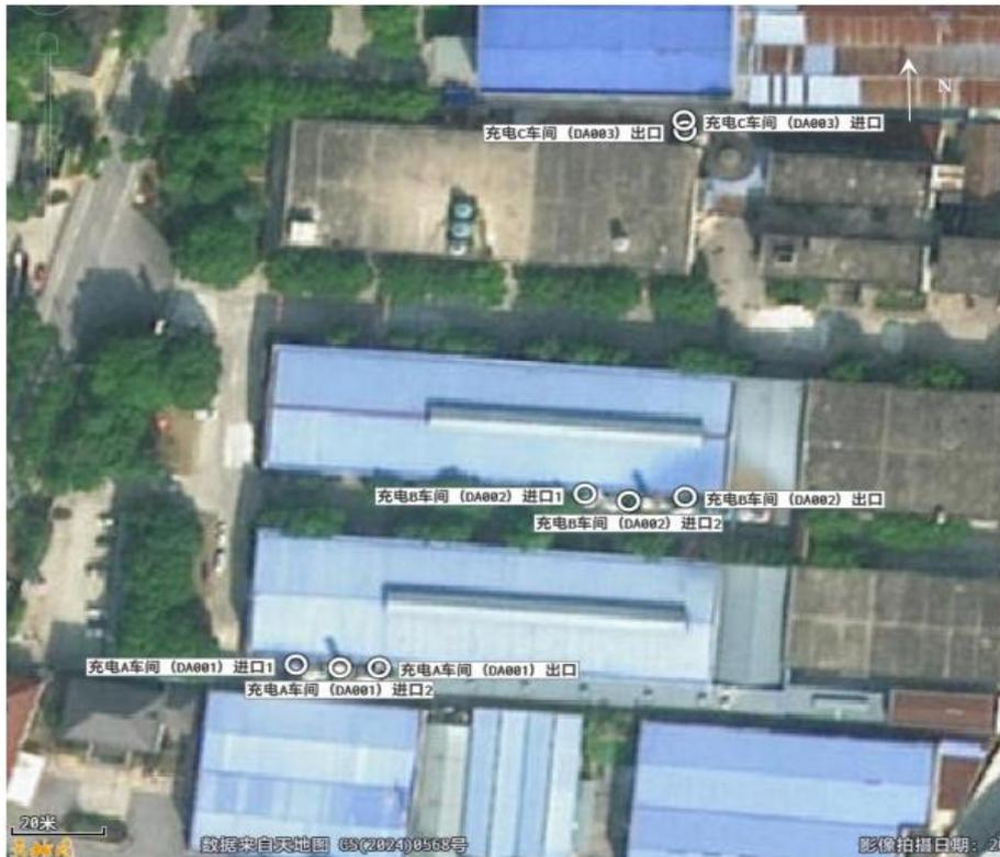
图 6-2 硫酸雾有组织废气监测布点图
