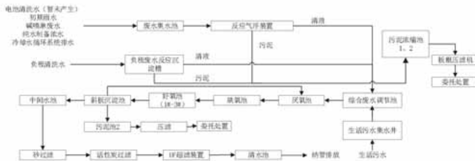
图 3-2 企业污水处理工艺流程图 单位 t/a
