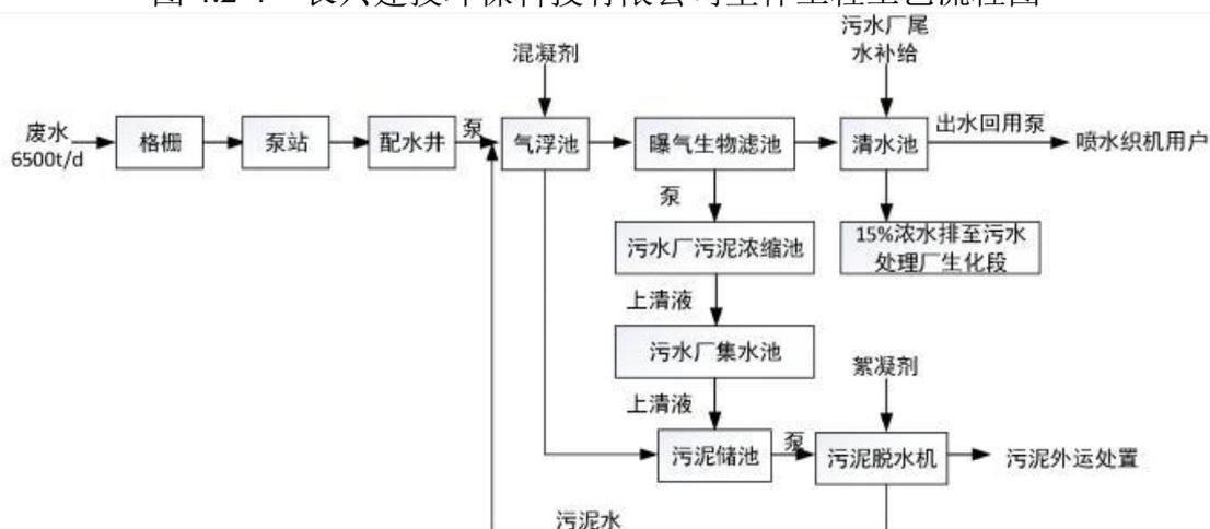
图 4.2-5 长兴建投环保科技有限公司中水回用工艺流程图
