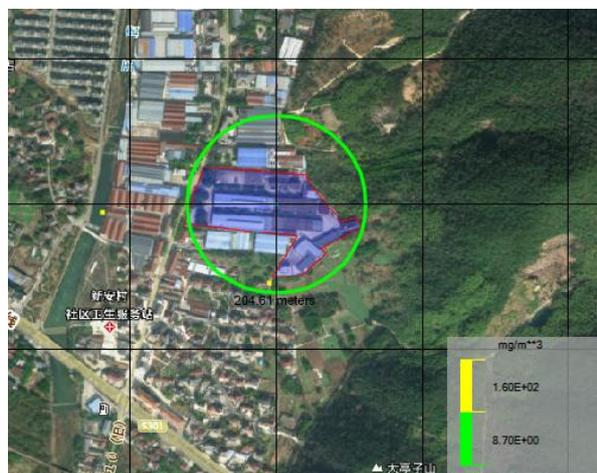
98 酸储罐破裂下风向最不利气象条件最大安全距离范围示意图
