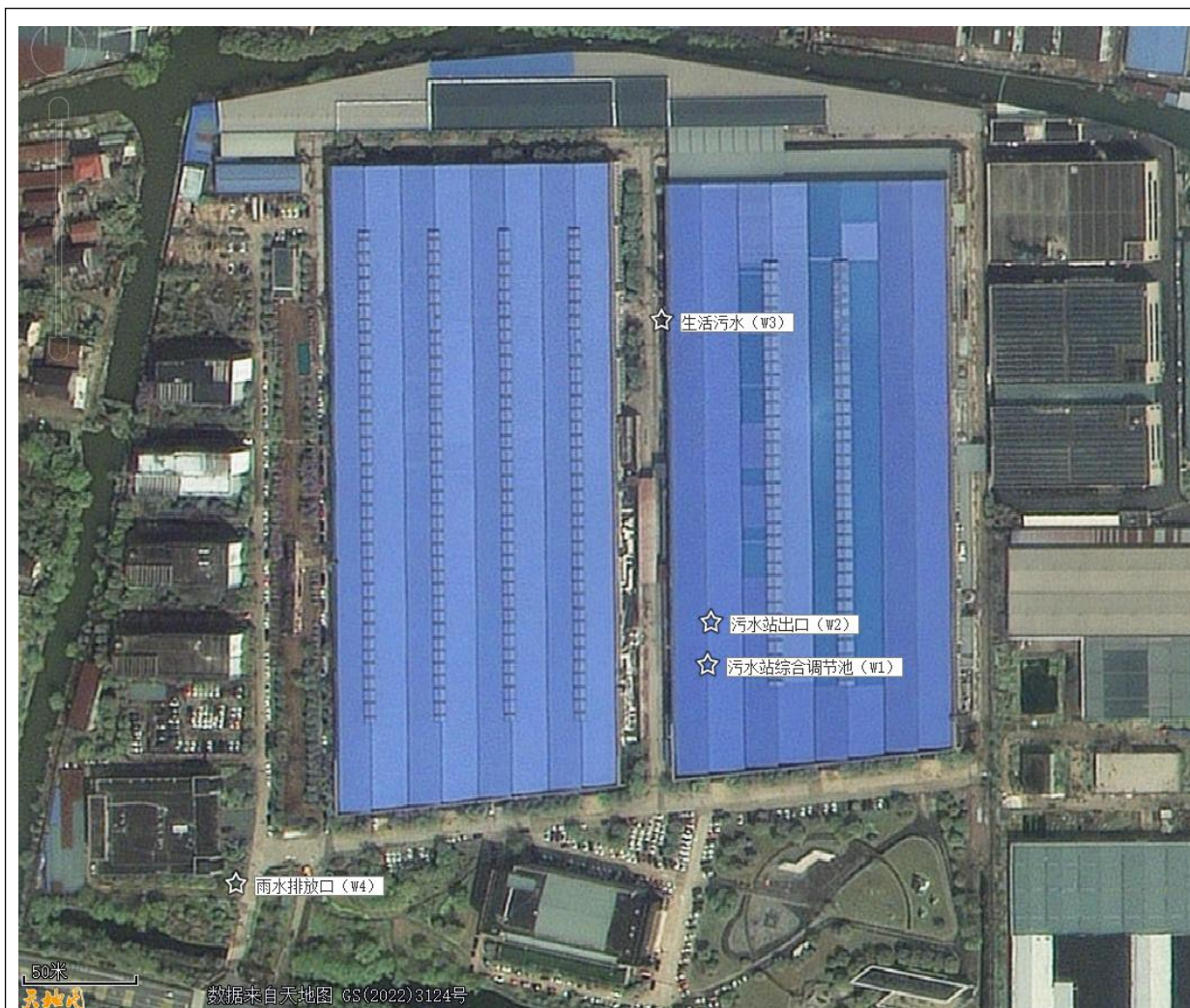
图 6-3 本项目废水监测点位示意图
