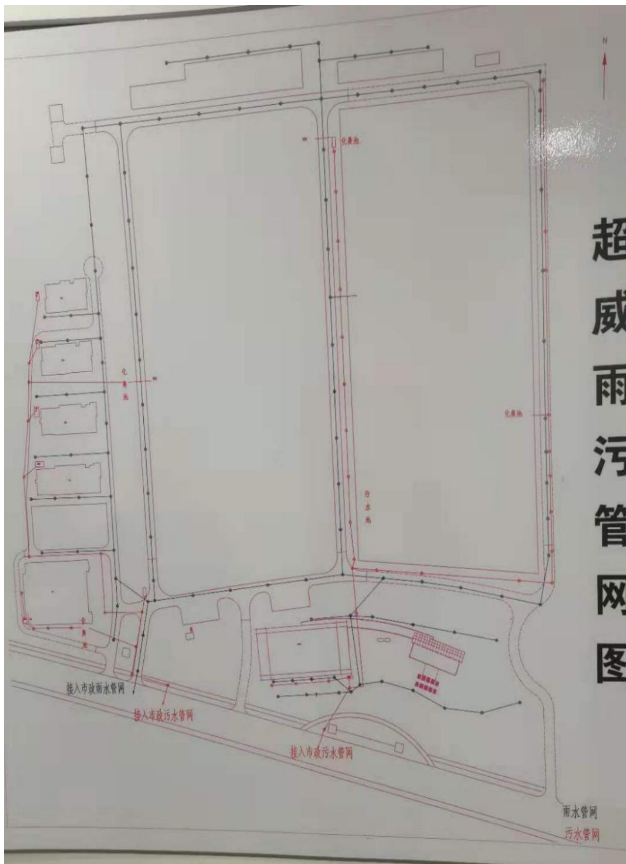
附图 3 厂区雨污管线布置示意图
