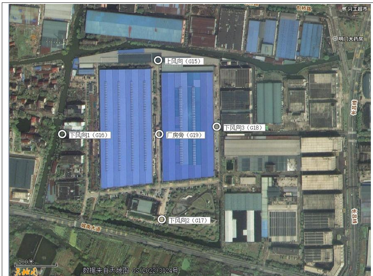
图 6-2 本项目无组织废气监测点位示意图
