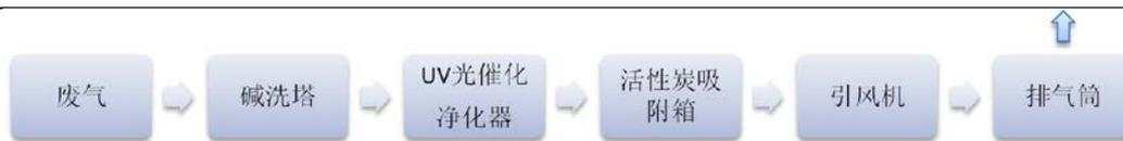
图 8-3 废气处理流程示意图
