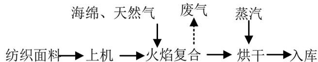
图 1-2 火焰复合工艺流程及产污环节示意图
