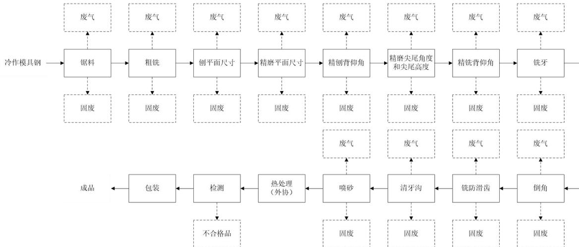
图 5-1 本项目生产工艺流程及产污环节图
