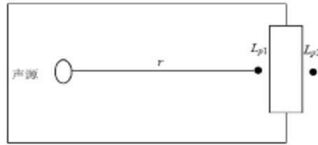
图 7.2 室内声源等效室外声源图例
